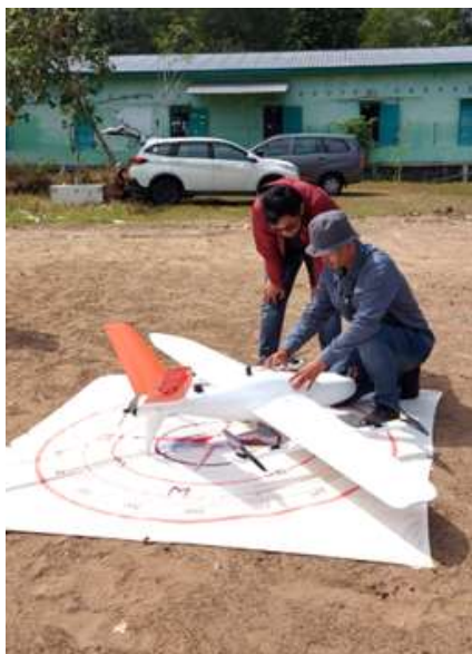
Gambar 5. Persiapan penerbangan wahana nir-awak tipe VTOL
