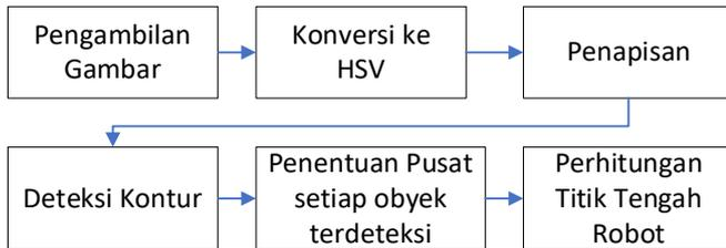
Gambar 2. Detail Mekanisme Identifikasi Lokasi Robot
